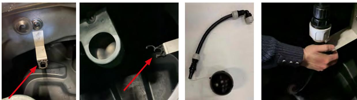
3. Dévissez le raccord à compression du kit KRAL32-1 et passez le tube Opal dans le joint à opercule « ASPIRATION ».
