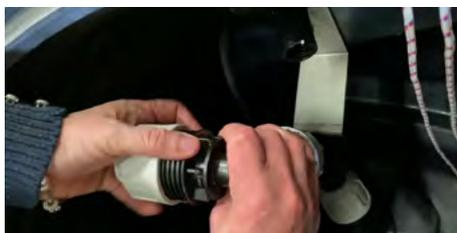
5- Positionnez-le sur le tube Opal du kit KRAL32-1 et assemblez les deux kits en vissant le raccord.
