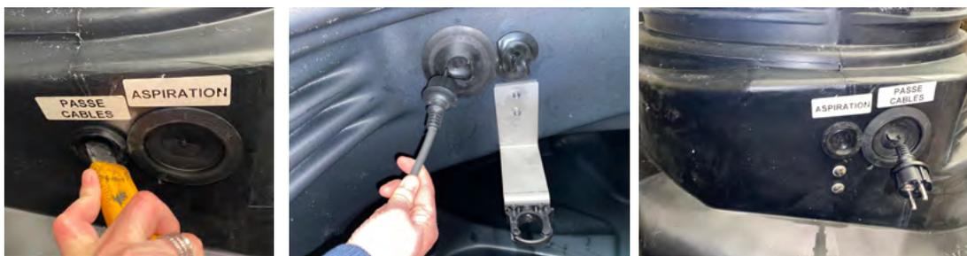
10. Ouvrir le collier monoklip (en appuyant dessus), Fixer le tube du KPI-1 sur le support disponible dans la cuve,
