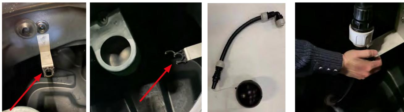
3. Dévissez le raccord à compression du kit KRAL32-1 et passez le tube Opal dans le joint à opercule « ASPIRATION ».
