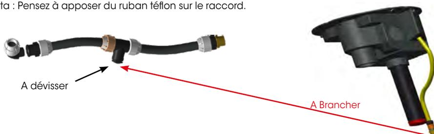
15. Branchez l'alimentation au choix : connectez le kit KRAL32-1 à une alimentation type robinet et le raccord rapide à un tuyau d'arrosage.
