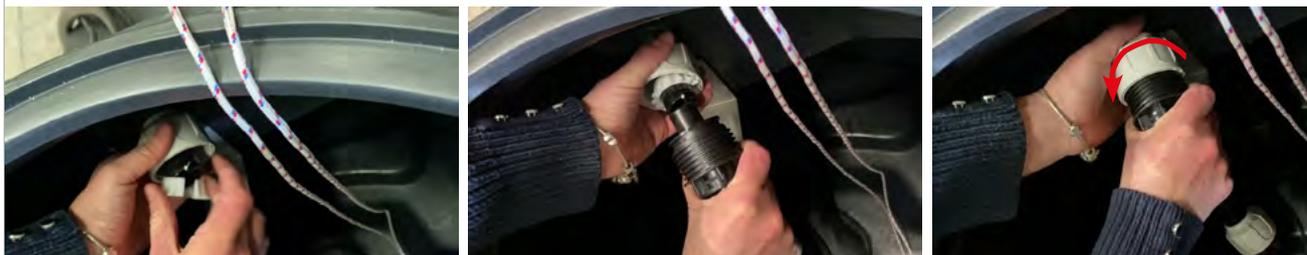
14. Dévissez le raccord sur le T du kit KPI-1 et branchez sur ce T le raccord du kit de refoulement.
